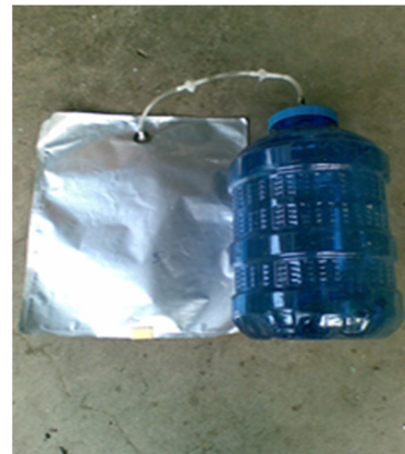
Hình 1: Bộ thí nghiệm ủ yếm khí theo mẻ
