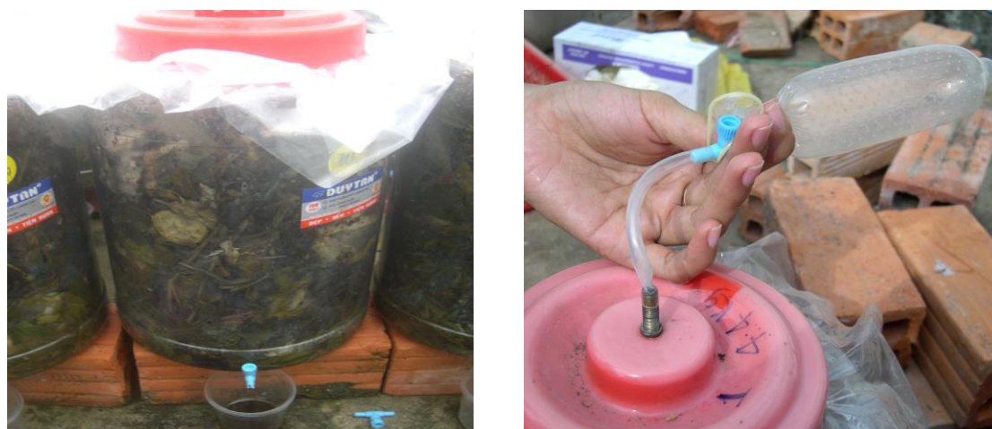
Hình 1: Mô hình thùng xử lý rác thải hữu cơ có dung tích 10-L với lỗ thoát nước rỉ rác lấy khí từ bình lên men 10-L
