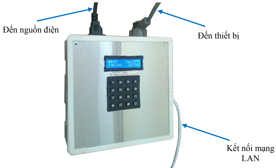
Hình 6: Sơ đồ kết nối module giám sát và thiết bị
